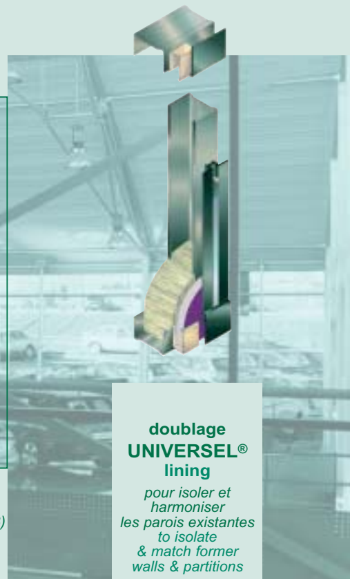
UNIVERSEL® 98 Hautes performances : feu (1H), acoustique (50dB) High performances : fire resistance (1H), acoustics (50dB)
